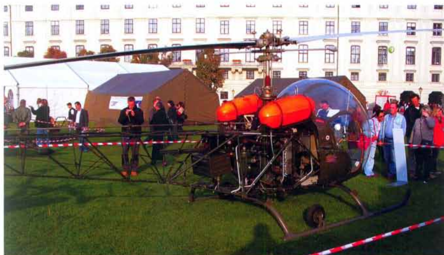
◀ Bell OH-13H Sioux ma przydomek „Fish Bowl” z racji wyglądu osłony kabiny pilotów wykonanej z tworzyw sztucznych. Zdjęcie zrobiono podczas plenerowej wystawy Sił Powietrznych Austrii w Wiedniu / Filip Kozarski
