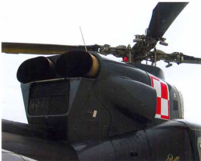
▲ Przedział silnikowy w ujęciu od tyłu z prawej strony. Widoczne są dwie dysze wydechowe odprowadzające spalinę z turbin / Patryk Janda
