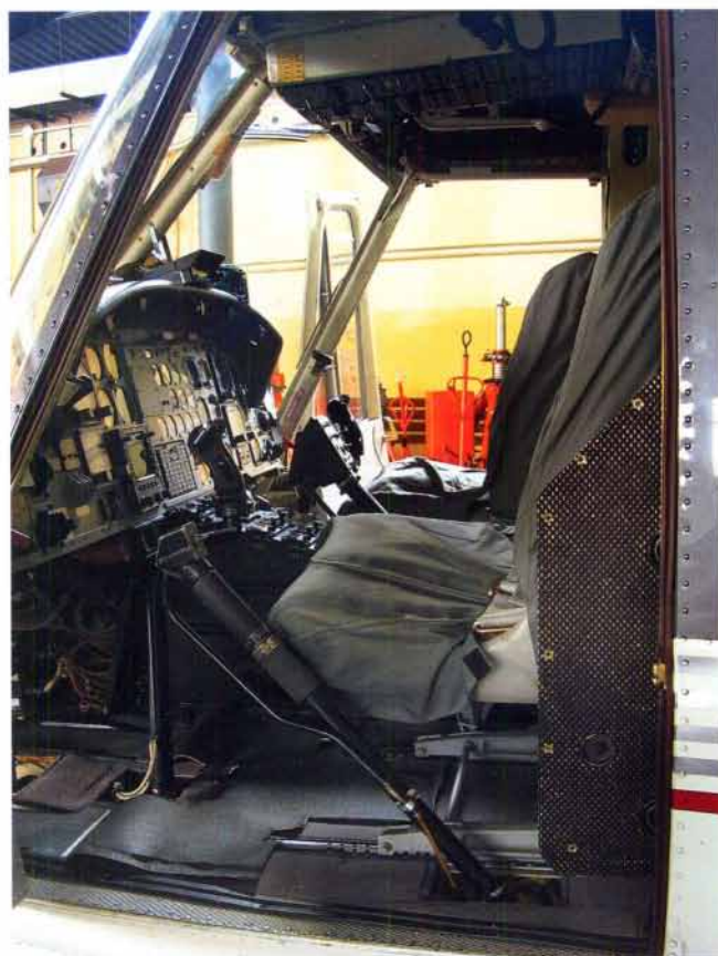
◀ Widok kabiny pilotów Bella 412 HP. Dobrze widoczne drążki sterowe oraz dźwignie skoku i mocy obu pilotów / Patryk Janda
