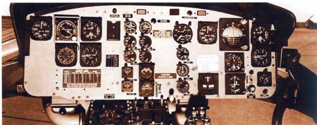
▲ Zbliżenie na pulpit Hueya. Ułożenie kontrolki jednoznacznie pokazuje, że dowódca śmigłowca siedzi po prawej stronie. Taki sam panel występuje w wersjach B, C i M / Bell
