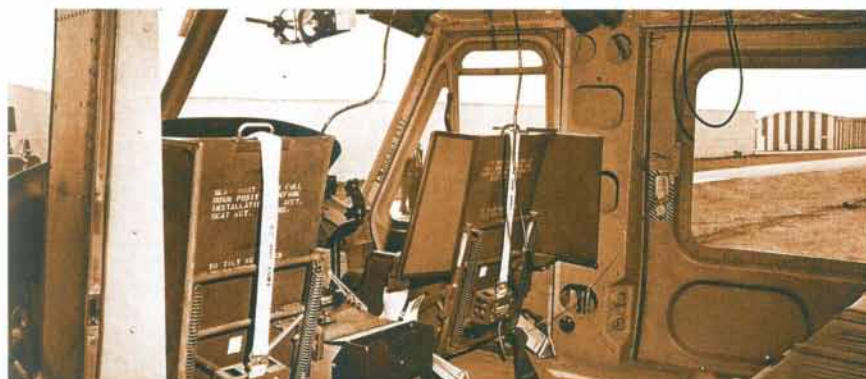
◀ Wnętrze Hueyów B, C i M było takie samo. Na tym zdjęciu dobrze widoczne są płyty pancerne chroniące pilotów, które zaczęło montować podczas wojny w Wietnamie / Bell
