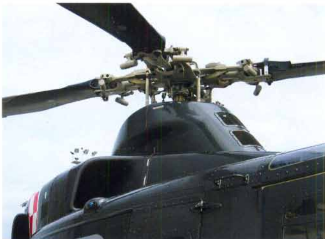
▲ Wlot powietrza do prawego silnika Pratt & Whitney Canada PT6T-3B-1 oraz dobrze widoczna głowica wirnika nośnego / Patryk Janda
