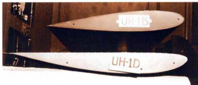
▲ Porównanie stateczników poziomych śmigłowca UH-1B i UH-1D. Wraz z „rozciągnięciem” kadłuba wersji D powiększono również powierzchnię usterzenia poziomego / Bell
