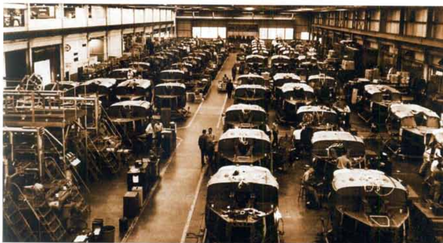
◀ Linia produkcyjna w fabryce Bella w Hurst w stanie Teksas. Widoczne na zdjęciu Hueys są w początkowej fazie budowy / Bell
