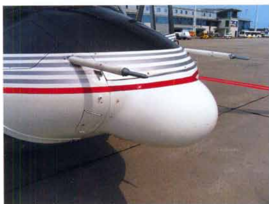
▲ Najbardziej charakterystyczny element całej rodziny Hueyów — szeroki i płaski nos. Na zdjęciu doskonale widać rurki Pitota oraz radar pogodowy / Patryk Janda
