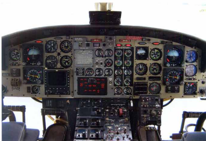
◀ Główny panel śmigłowca Bell 412 HP. U dołu zdjęcia można zauważyć napis BELL na pedałach / Patryk Janda
