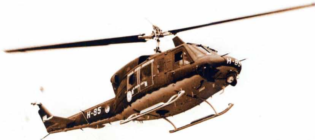
▲ UH-1N należący do sił powietrznych Argentyny. Pod nosem śmigłowca widoczny szperacz, który wykorzystywano podczas misji ratunkowych / Bell
