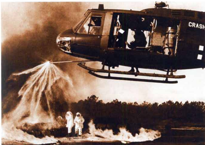
◀ Ćwiczenia w bazie sił powietrznych USA Pope w Północnej Karolinie. Śmigłowiec HH-1D Crash/Rescue taruje strażakom drogę do płonącego wraku samolotu. W przedziale ładunkowym widać zbiornik z płynem gaśniczym oraz wyciągarke / US Army
