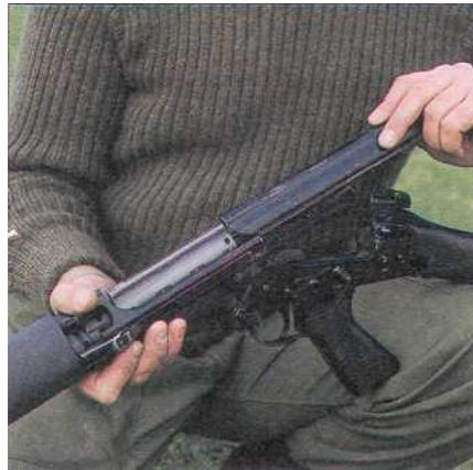
2. Отведите назад крышку ствольной коробки и снимите ее. При открытой винтовке не нажимайте спусковой крючок.
