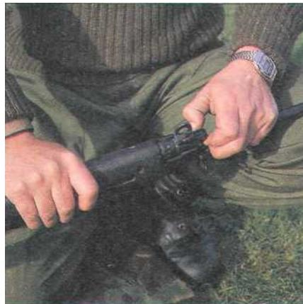
5. Затем разбирается механизм отвода газов. Вставьте кончик пули в отверстие крышки газовой камеры, поверните крышку на четверть оборота вниз и снимите ее. Извлеките газовый поршень.
