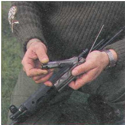
4. Поднимите передний срез затвора вверх и извлеките его из затворной рамы. Ударник и ограничитель хода вынимаются вместе с нижней частью выбрасывателя.
