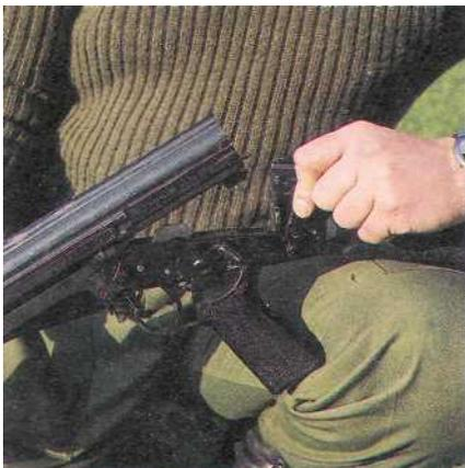
1. Отсоедините магазин, отведите затвор назад и осмотрите патронник. Верните затвор в переднее положение, и поверните защелку ствольной коробки против часовой стрелки, чтобы открыть ствольную коробку.
