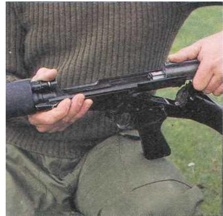
3. Отсоедините возвратный поршень и, захватив снизу рукой затворную раму, извлеките ее из ствольной коробки.
