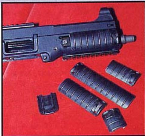
**Zubehör-Menge:** Die Picatinny-Schienen können mit Griffschalen überdeckt werden, die auch den Vorderschaft breiter machen. Rechts: der Dämpfer mit ZF-Montageschienen, Zweit-Riemenbügel, der Vordergriff und das separat abkoppelbare Magazin-Paket.
