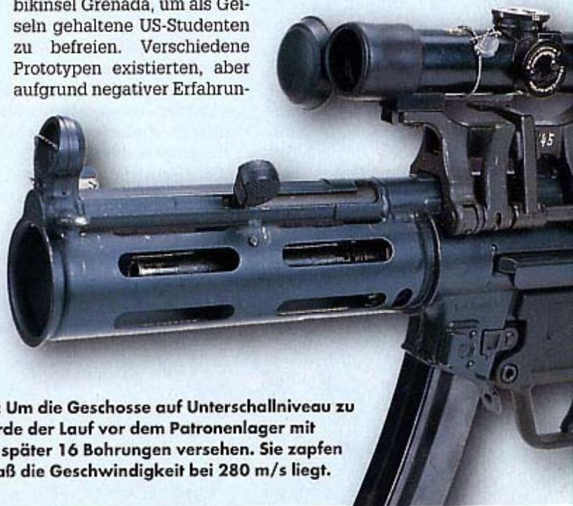
Loch an Loch: Um die Geschosse auf Unterschallniveau zu drücken, wurde der Lauf vor dem Patronenlager mit zunächst 12, später 16 Bohrungen versehen. Sie zapfen Gas ab, so daß die Geschwindigkeit bei 280 m/s liegt.
